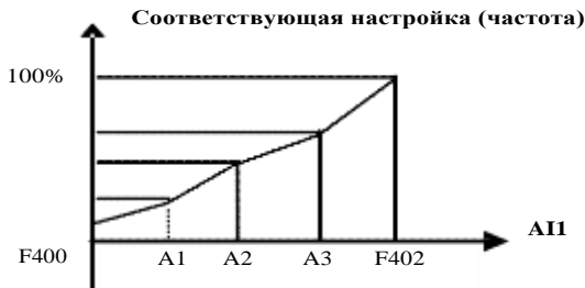
Рис. 6-17 Значение параметра криволинейного аналогового сигнала
